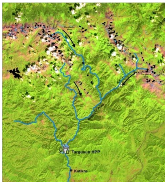
Рис. 1. Верховья р. Тургусун, с. Кутиха и ГЭС. Стрелками отмечены возможные пути стока в результате прорыва моренного озера. Снимок Ландсат (свободно распространяемый).
